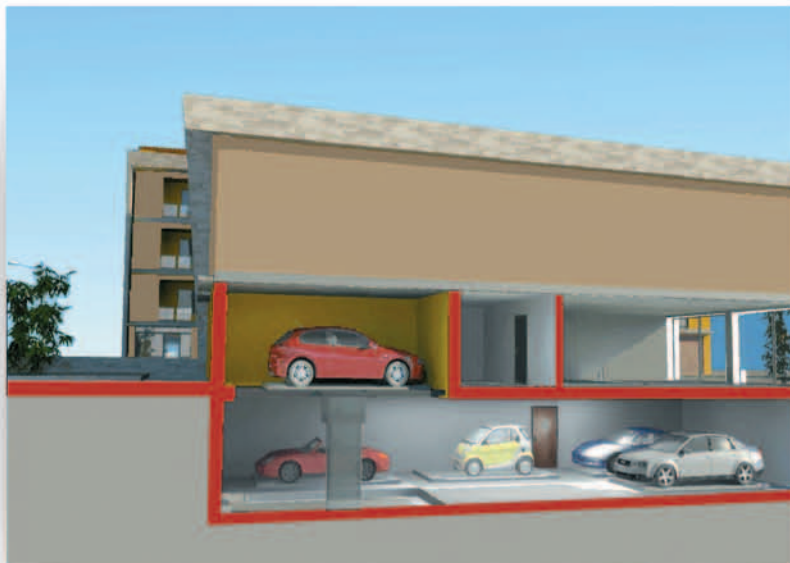
5 posti automatizzati più 1 manuale. Area occupata 100 m 2 .
