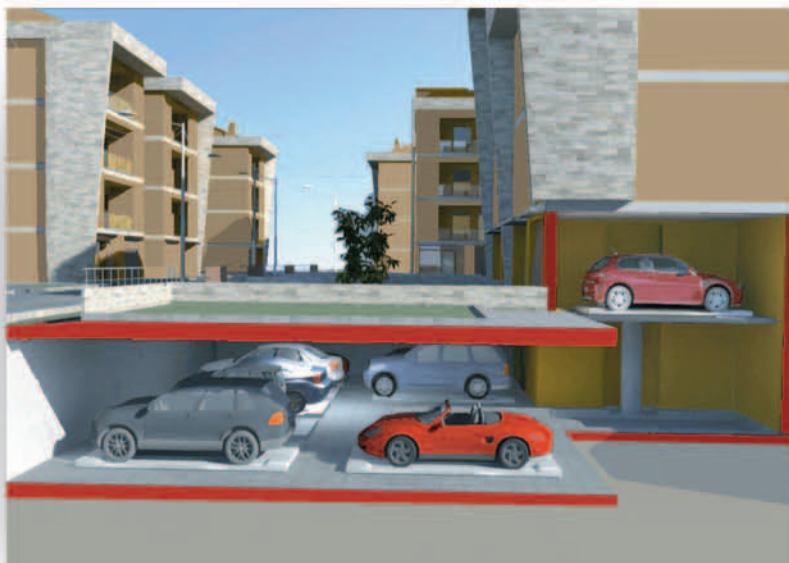
9 posti automatizzati più 1 manuale. Area occupata 150 m 2 .
