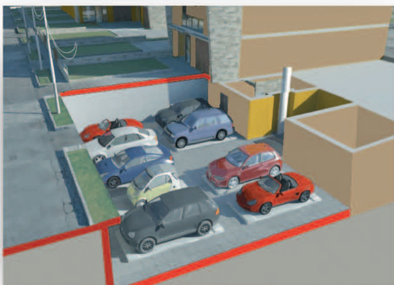
9 posti automatizzati più 1 manuale. Area occupata 150 m 2 .
